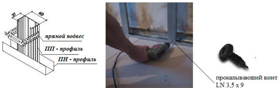
Рис. 1. Основные элементы сборной конструкции облицовки стен, колонн и откосов из ПН и ПП профилей
