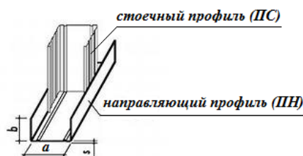
Рис. 2. Основные элементы сборной конструкции облицовки перегородок из ПН и ПС профилей
